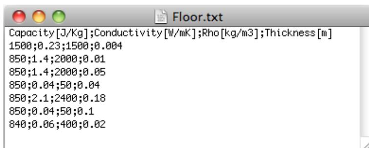
Figure 94 : Exemple de fichier décrivant la composition spécifique d'une paroi (ici le sol).
